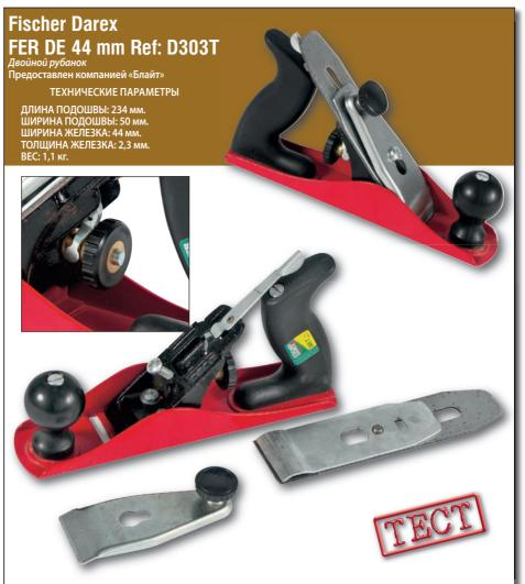
Колодка рубанка из изогнутого стального листа, «лягушка», очевидно, приварена электросваркой, регулировка выдвижения и устранение перекосов железка, как у многих других рубанков, — латунной гайкой на горизонтальном винте сзали и рычагом позали лезвия. Прижим винтовой, с черной пластиковой ручкой. Подошва колодки отшлифована продольно, имеет продольные риски, но достаточно ровная. Ручки общепринятой формы изготовлены из пластика, задняя пистолетная и передняя в виде шара на короткой ножке.
