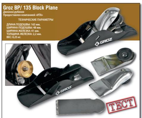
Маленький двойной рубанок стнутой из стального листа колодкой, без ручек — ее частично заменяет выпуклая ложкой поверхность стружколома и часть торца прижимного винта. Минималистская, компактная конструкция «детского» по виду рубанка подойдет для работ, выполняемых моделистами или краснодеревщиками.
