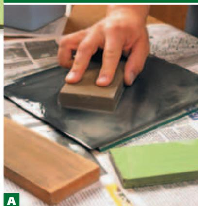
**А** Мелкие царапины на рабочей стороне, такие как на левом камне, означают, что его поверхность нуждается в шлифовке на мокрой абразивной бумаге.
