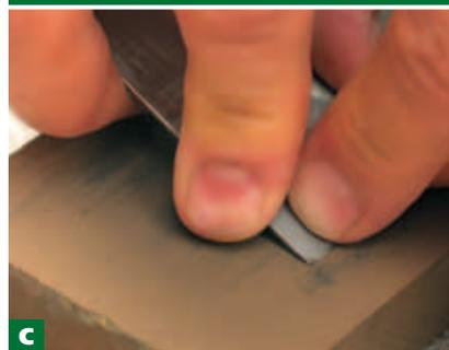
**С** Заточивая любые стамески (кроме самых узких), двумя пальцами равномерно и плотно прижимайте лезвие фаской к камню. Другой рукой держите инструмент под нужным углом.
