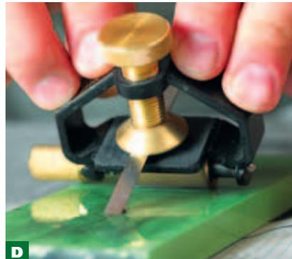
**Д** Пользуйтесь заточным приспособлением, пока не научитесь прижимать фаску лезвия рубанка или стамески к поверхности камня всей плоскостью и удерживать постоянный наклон инструмента.
