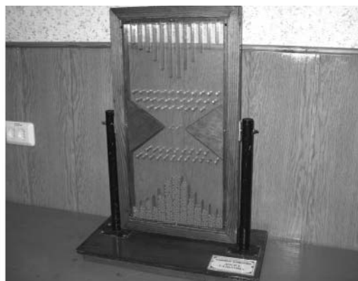
Рис. 4. Схема лабораторной установки Рис. 5. Лабораторная установка – доска для анализа статистических закономерностей
