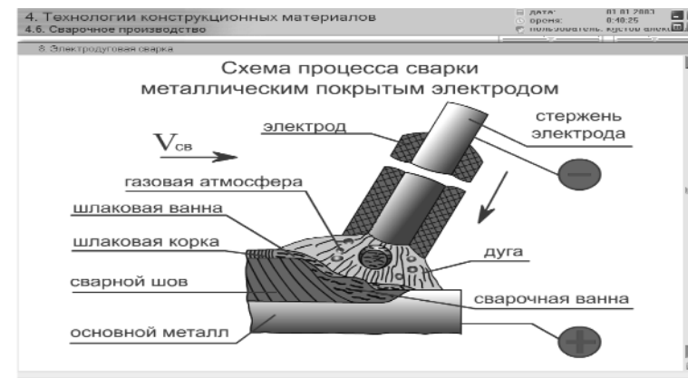
Рис. 7. Схема процесса сварки как элемент ЦОР «Сварочное производство»
